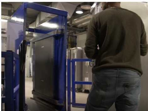
Ci-contre : portique de contrôle radiologique développé par UNITECH SERVICES
